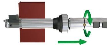
Avvicinare velocemente la superficie di lavoro. L'utensile è progettato per lavorare ad alte velocità di rotazione con limitato avanzamento.
