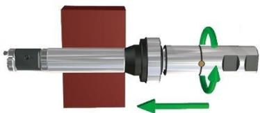
Refrigerante esterno ON, refrigerante attraverso il mandrino OFF. Ingresso nel foro in rotazione destra (100 g/min) fino al contatto del cono di spinta con la superficie.
