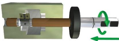
Se modello con opzione lamatura frontale. Avanzamento rapido per l'avvicinamento alla superficie frontale, lavorazione alla velocità consigliata e breve sosta per ripulire il taglio (1-3 giri).
